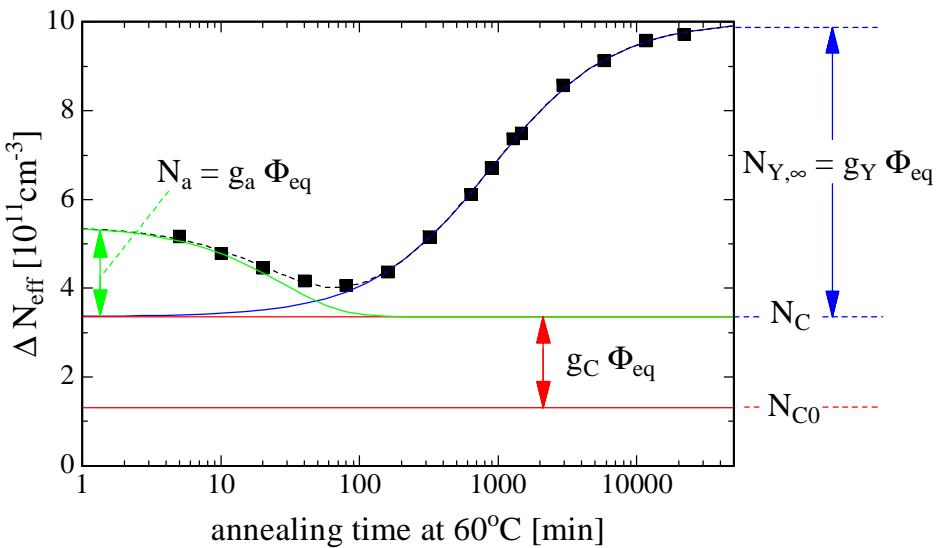
$$\Delta N_{\text{eff}}(F_{\text{eq}}, t) = N_a(F_{\text{eq}}, t) + N_C(F_{\text{eq}}) + N_Y(F_{\text{eq}}, t)$$
